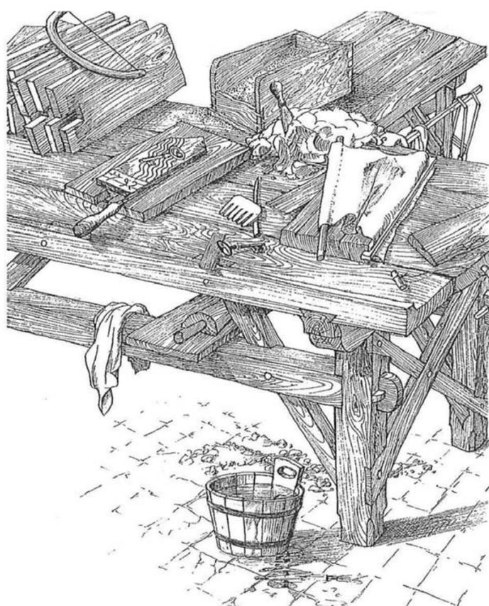
Ziegel wurden stehend an einem Tisch hergestellt. Der Lehm wurde von Hand in eine Form gepresst und der Überschuss mit einem Bogen abgezogen. Bild: vfg
