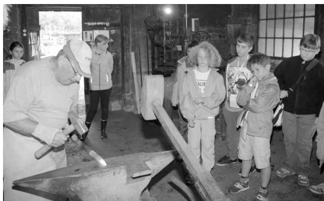
In der alten Schmitte Fehr wird ein glühender Meissel zugespitzt
