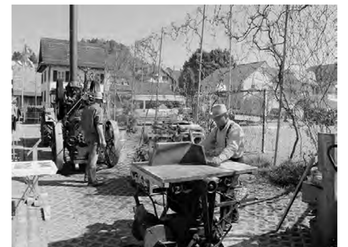
Robert Kern fräst Holz mit dem generierten Strom der Dampfmaschine
