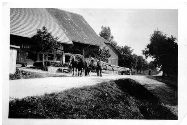
Pferdefuhrwerk mit Langholz vor 1950. Die Ketten umwinden die Ladung und sind mit «Brüechbengeln» gespannt. Der «Wepfer» steuert hinten die Fuhre um die Kurven herum.
