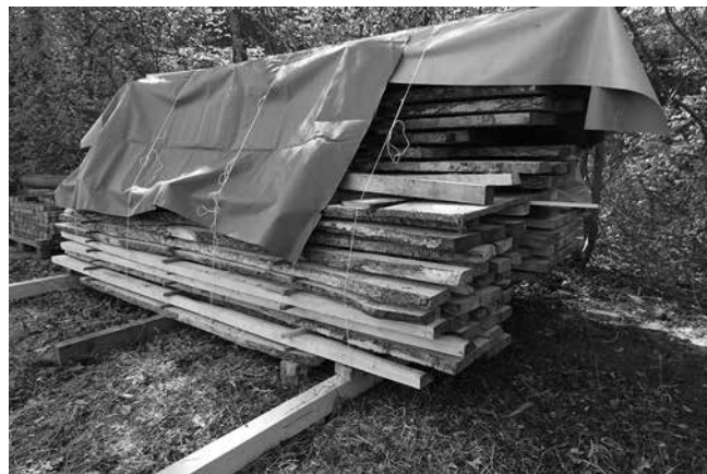
Ein stattlicher Stapel Eschenbretter liegt bereit für die Da Vinci Brücke
